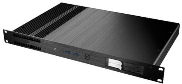
Der *athletec*® FlatLine ist ein industrieller 1HE Rackmount Computer, der sich trotz des kompakten und lüfterlosen Aufbaus, durch seine sehr hohe Performance auszeichnet. Ausgestattet mit einer Intel® Core Core i7-13700T CPU und mit 16 Gigabyte RAM Arbeitsspeicher, ist dieser Rechner die optimale Alternative für Applikationen, die hohe Leistung bei einem niedrigen Geräuschpegel benötigen. Das 19-Zoll-Gehäuse aus robustem Aluminium ermöglicht den problemlosen Einbau in einen Schaltschrank.
